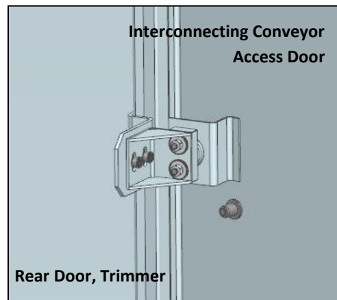
Fig. 4 - Neodymium Magnet Door Catch Assembly
